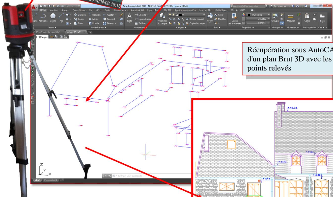
Récupération sous AutoCAD d'un plan Brut 3D avec les points relevés
