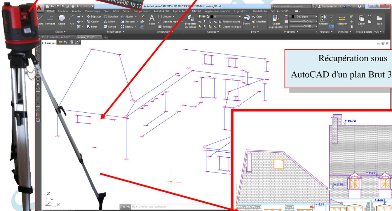
Récupération sous AutoCAD d'un plan Brut 3D
