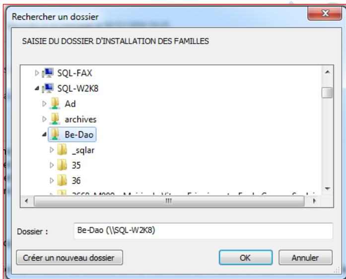
2.7. Une seconde fenêtre apparaît, elle permet d'indiquer à quel emplacement le dossier Familles est installé. Ce dossier contient les dessins avec les blocs de la bibliothèque. Il est ainsi possible de positionner et partager ce dossier sur plusieurs stations (toujours le placer en sous-répertoire d'un dossier \_sqlar) voir
